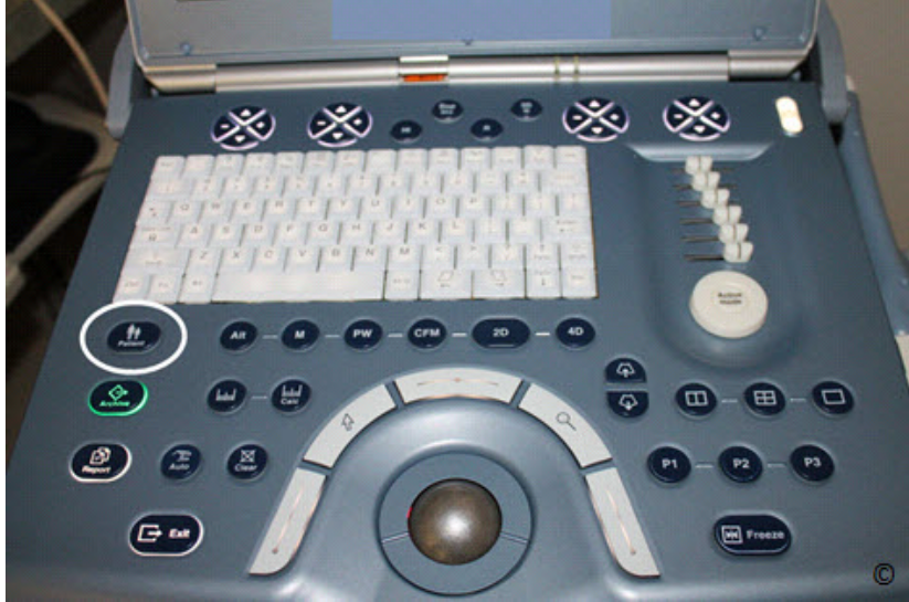
그림 2.18: 초음파 장비 패널에 “Patient” (흰색동그라미) 버튼을 누르면 환자 정보 입력 화면으로 전환된다. 초음파 검사를 시작하기 전에 반드시 환자 정보를 입력하도록 한다.
