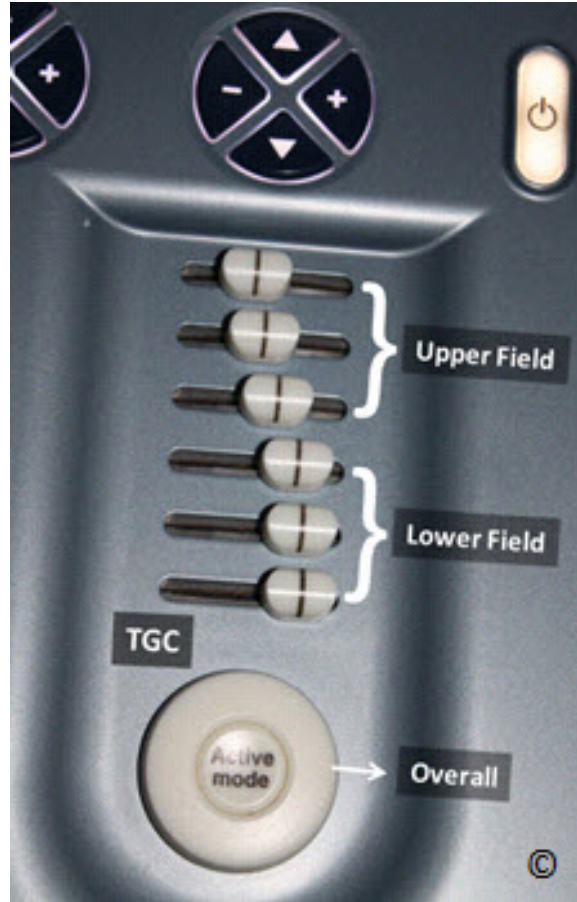
그림 2.12: 장비 패널 상에 있는 시간 수신 강도 보정 단자. 위쪽과 아래쪽 단자들은 각각 상응하는 화면 상단과 하단 영역의 밝기를 조절한다. 사진 아래쪽에 보이는 원형버튼은 전체 화면의 밝기를 한꺼번에 조절하고자 할 때 사용할 수 있다.
