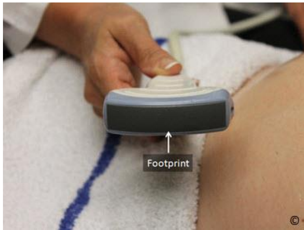
Obrázek 2.1: Aktivní plocha (angl. footprint ) konvexní abdominální sondy. Aktivní plocha, která odesílá a přijímá zvukové vlny.
