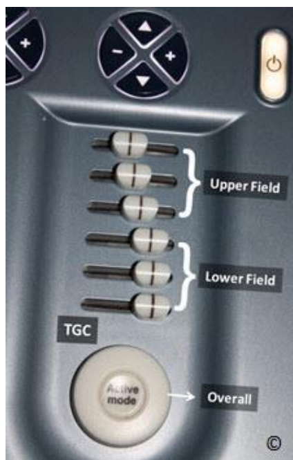
Obrázek 2.12: Hloubková kompenzace zesílení (TGC) na ovládacím panelu ultrazvukového přístroje. Horní a dolní ovladače upravují jas v horním a dolním poli (viz označení). Ovladač celkové TGC (viz označení) upravuje jas celého obrazu.
